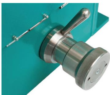
Устройство регулировки зазора между щеками ЩД 6М и ЩД 10М
