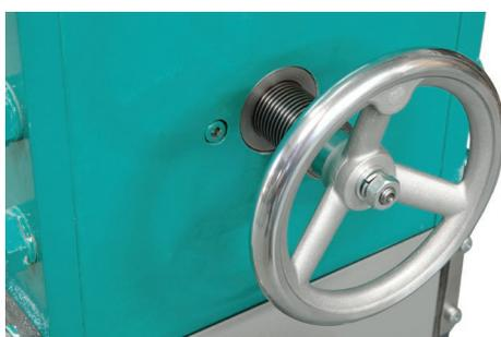
Устройство регулировки зазора между щеками **ЩД 15**
