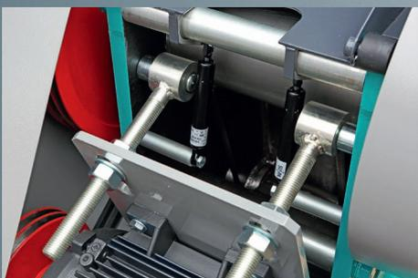
Устройство регулировки натяжения ремней электродвигателя дробилки ЩД 15
