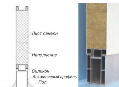
Cleanroom панель монтирована на алюминиевый профиль
