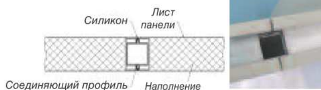
Горизонтальное соединение панелей Cleanroom
